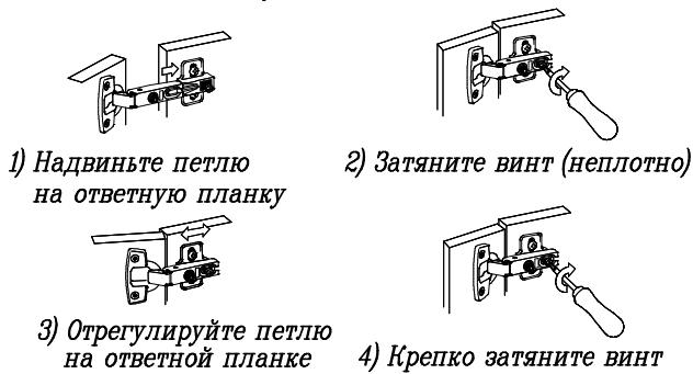
*Схема регулировки петли*
