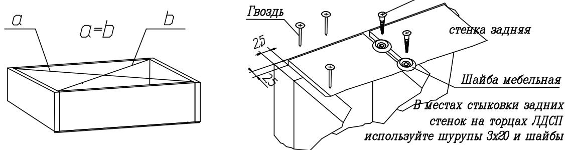
Начните сборку каркаса. Проверьте перпендикулярность и параллельность щитов и зафиксируйте с помощью задней стенки из ДВП, как указано на рисунке, не нарушая диагонали. Помните, что от этого зависит правильность работы выдвижных ящиков и створок.
