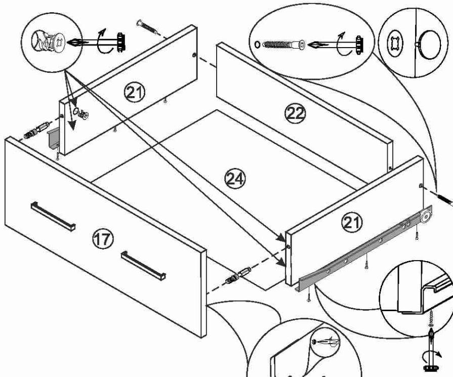
1. Бока ящика 21 скрепляем с задником 22 еврошурупами и панелью ящика эксцентриками.
