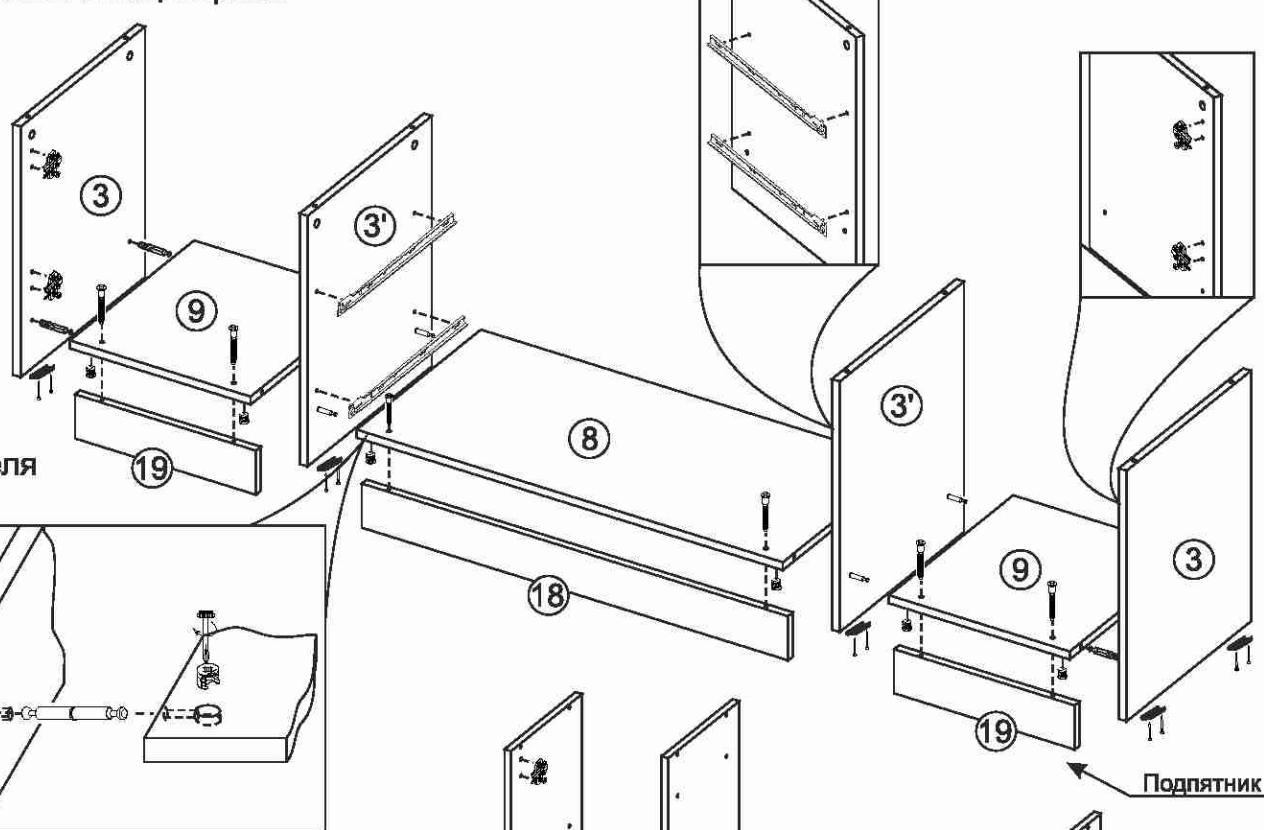
2. Подготовленные боковины 3 и 3' соединить между собой вязками 8 и 9 и зафиксировать эксцентриковыми стяжками. К установленным вязкам 8 и 9 прикрепить цоколя 18 и 19 соответственно при помощи еврошурупов. При помощи гвоздей прикрепить подпятники.
