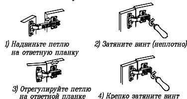
Схема установки петли
