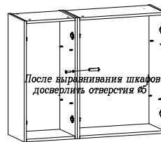
Установка и стяжка корпусов шкафов
