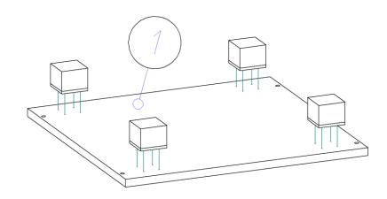
2. В отверстия на боках (2,3) устанавливаем штоки стяжек эксцентриковых и забиваем шканты 8\*30. Важно: установка шкантов производится только на ровной твердой поверхности во избежание порчи детали.
