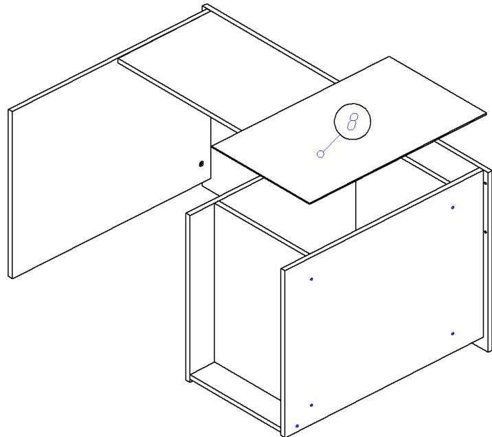
6. Соберем ящики. Евровинтами скрепляем бока ящика (Я.1, Я.2) и панель ящика (Я.3), прибиваем дно ящика ДВП (Я.5) (свес ДВП с незакромленной стороны 6 мм). С помощью эксцентриковой стяжки крепим фасад (Я.4) к коробу ящика (ДВП попадает в паз фасада). Прикручиваем с помощью саморезов 3,5\*16 направляющие на ящики.
