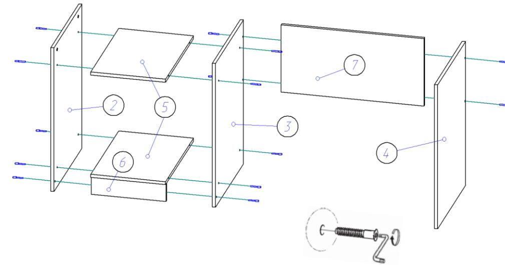
4. При помощи стяжек эксцентриковых и шкантов 8\*30 крепим столешницу (1) к стоевым (2,3,4), как показано на рисунке.
