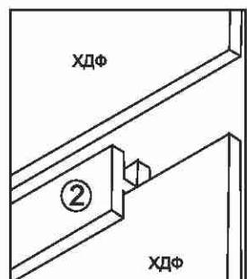
3. Вязку 4 соединить с боковинами 1 с помощью еврошурупов 7\*50мм.
