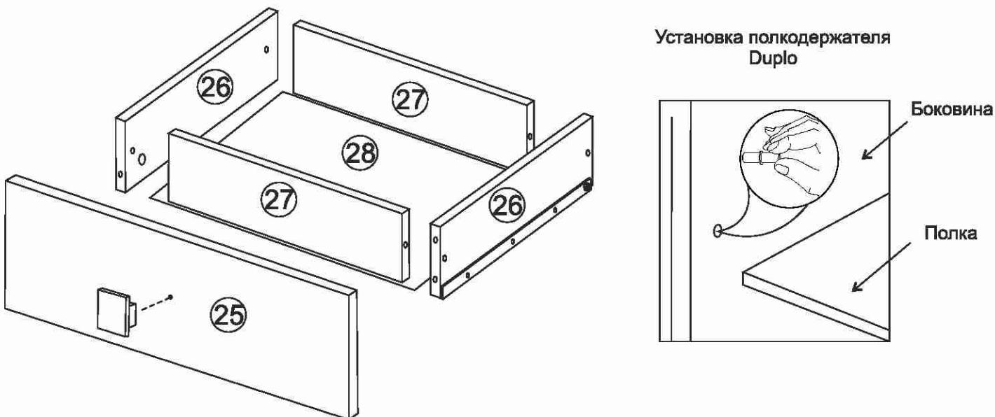
15. Предварительно перед установкой ручек глухие отверстия на фасадах просверлить до сквозных, затем закрепить ручки с помощью саморезов.
