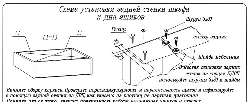
Начните сборку каркаса. Проверьте перпендикулярность и параллельность щитов и зафиксируйте с помощью задней стенки из ДВП, как указано на рисунке, не нарушая диагонали. Помните, что от этого зависит правильность работы выдвижных ящиков и створок
