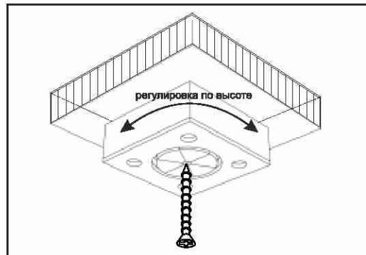
1. Перед сборкой определить место установки набора, вскрыть пакеты и согласно схеме сборки прикрепить необходимую фурнитуру по наколкам и отверстиям. После этого можно приступать к сборке согласно схеме.
