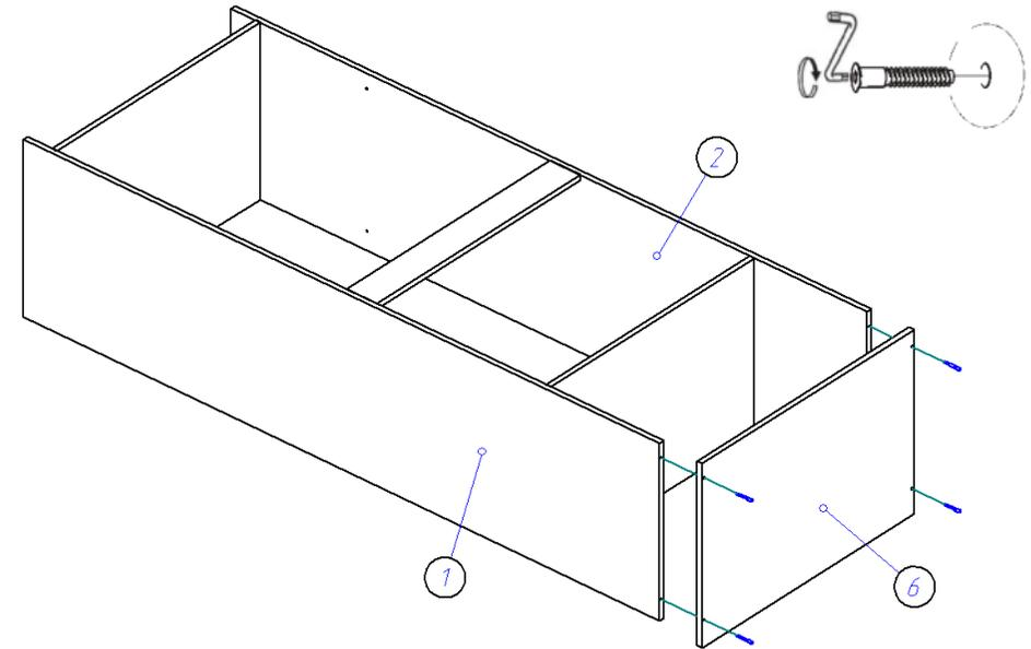
4. Каркас шкафа переворачиваем лицевой стороной вниз, проверяем равенство диагоналей и гвоздями 1,2\*20 прибаваем задние стенки ДВП (7), вставив между ними соединительный профиль.
