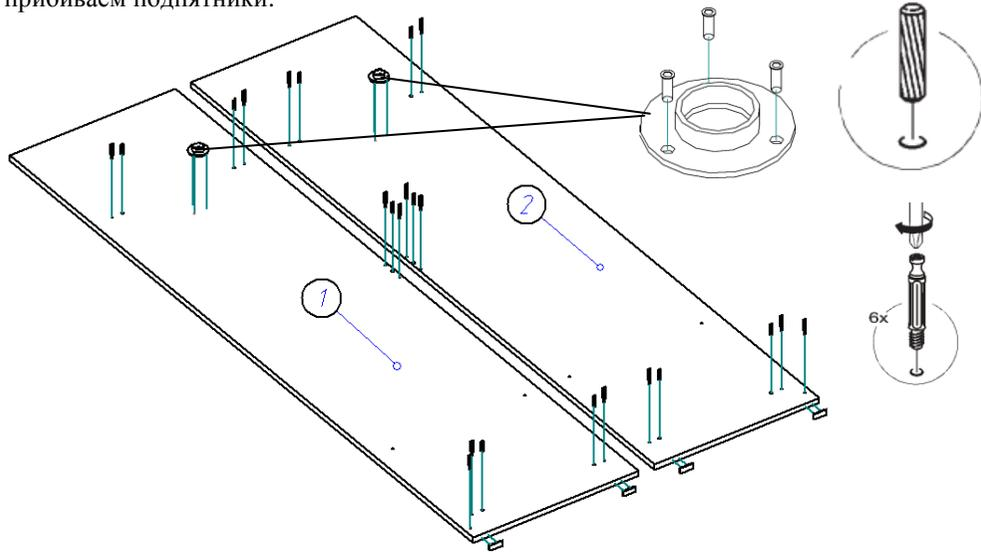
2. При помощи шкантов 8\*30 и стяжек эксцентриковых к бокам (1,2) крепим горизонты (3), панель фронтальную (4) и цоколь (5). Во фланцы при этом устанавливаем трубу.
