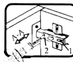
Если фасад наклонен вправо или влево относительно вертикали корпуса, нужно выпрямить наклон фасада в направлении А-А винтом 2.
