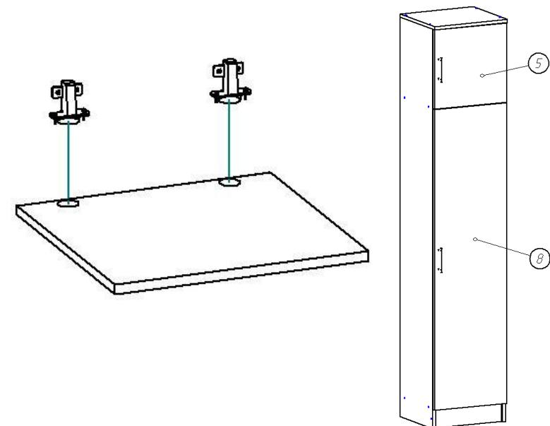
6. После того как навесили фасады (5) и (8) надо произвести регулировку их положения при помощи регулировочных и установочных винтов (рис).
