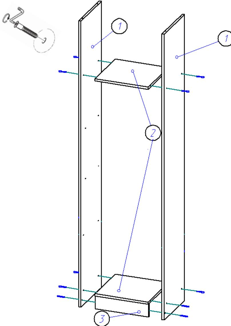
2. К полученной конструкции (см. пункт 1) с помощью евровинтов крепим крышку.
