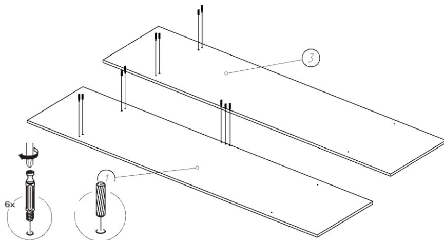
2. При помощи стяжек эксцентриковых и шкантов 8\*30 соединяем бок (1) и стоевую (3) с горизонтом (5) и распоркой (6).
