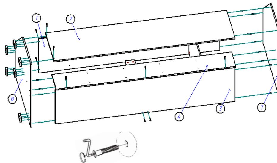
4. Переворачиваем корпус шкафа лицевой стороной вниз, выравниваем диагонали и гвоздями 1,2\*20 прибиваем задние стенки ДВП (9), предварительно установив между ними соединительный профиль. Переворачивает шкаф на другой бок и гвоздями 1,2\*20 прибиваем заднюю стенку ДВП (10).
