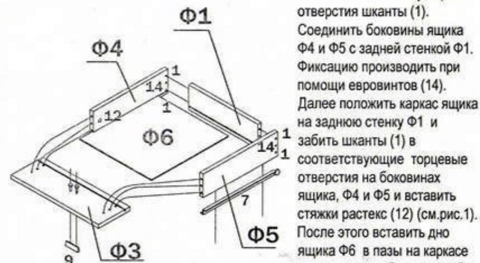
Взять стенку заднюю выдвижного ящика Ф1 и забить в соответствующие отверстия шканты (1). Соединить боковины ящика Ф4 и Ф5 с задней стенкой Ф1. Фиксацию производить при помощи евровинтов (14). Далее положить каркас ящика на заднюю стенку Ф1 и забить шканты (1) в соответствующие торцевые отверстия на боковинах ящика, Ф4 и Ф5 и вставить стяжки растекс (12) (см.рис.1). После этого вставить дно ящика Ф6 в пазы на каркасе ящика, таким образом, чтобы дно ящика Ф6 вошло в паз на стенке задней ящика Ф1.
