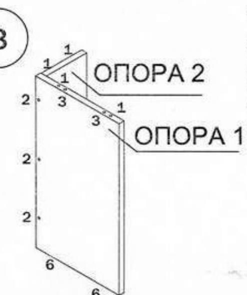
Закрутить в муфты столешницы Стол угол 120 дюбеля стяжек-растекс (4). Соединить столешницу с каркасом тумбы и опорой.
