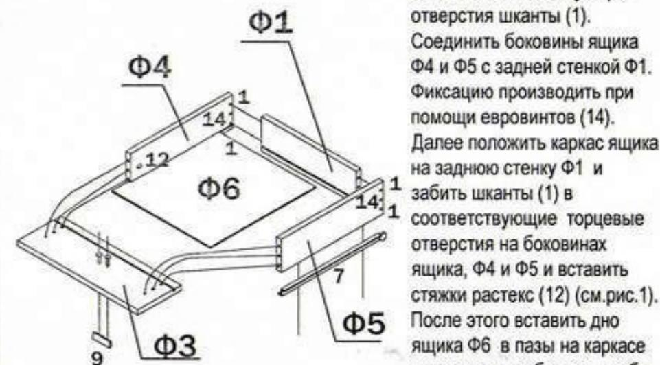
Взять стенку заднюю выдвижного ящика Ф1 и забить в соответствующие отверстия шканты (1).
