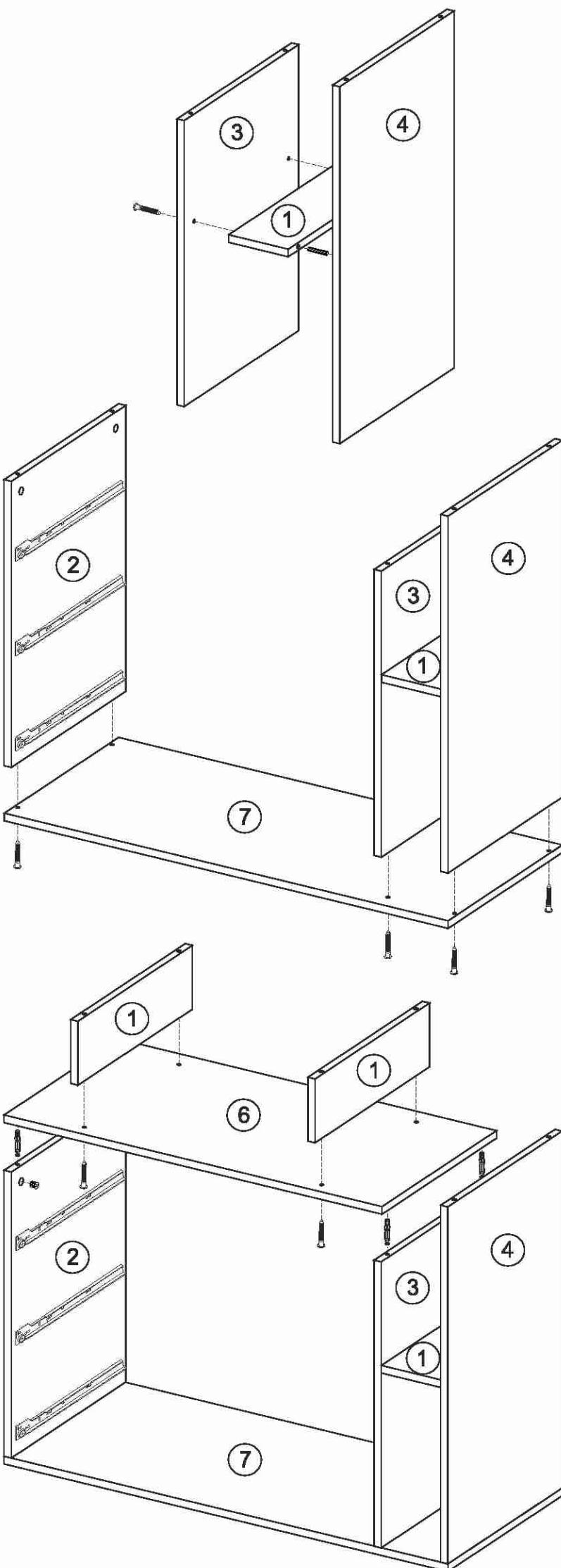
3. Подготовленную боковину 3 и боковину 4 скрепить между собой боковиной 1 при помощи шкантов, посаженных на клей, и еврошурупов 7\*50 мм и шкантов.
