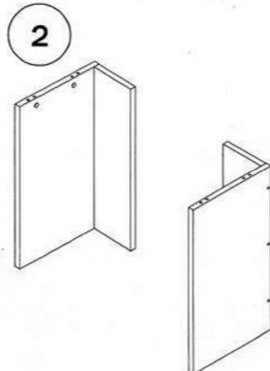
2. Собрать два комплекта СКЛ при помощи евровинтов 7\*70 мм
