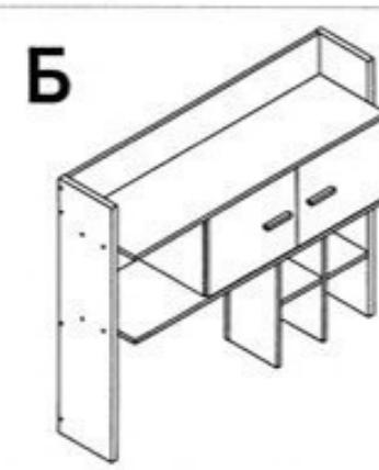
Разные виды исполнения достигаются путем поворота полок и других элементов конструкции , при этом боковины и царга свои места не меняют.
