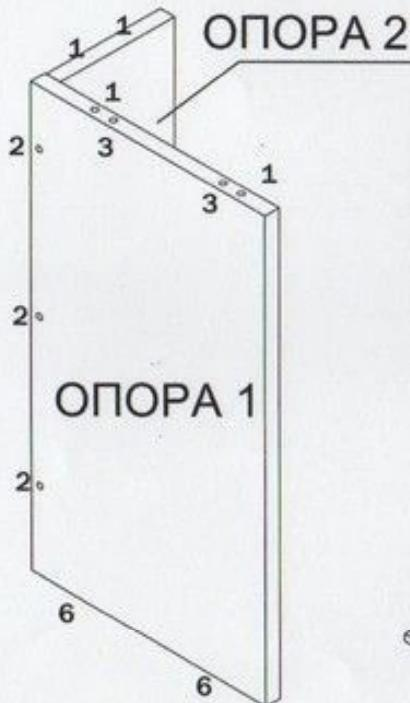
2. Закрутить дюбеля стяжки-растекс (4) в солешницу СКЛ ИГР-140-01. Прикрутить опоры 720 как показано на сх.2. саморезами (9). Соединить столешницу с опорами ОПОРА 1 и ОПОРА 2 собранными в п.1 При необходимости произвести регулировку опор 720 по высоте.
