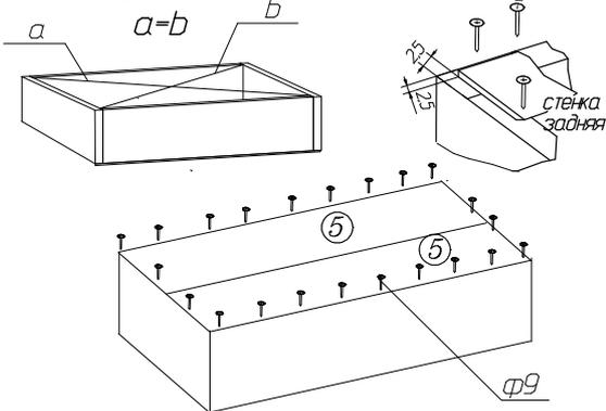
Начните сборку каркаса. Проверьте перпендикулярность и параллельность щитов и зафиксируйте с помощью задней стенки из ДВП, как указано на рисунке, не нарушая диагонали. Помните, что от этого зависит правильность работы выдвижных ящиков.
