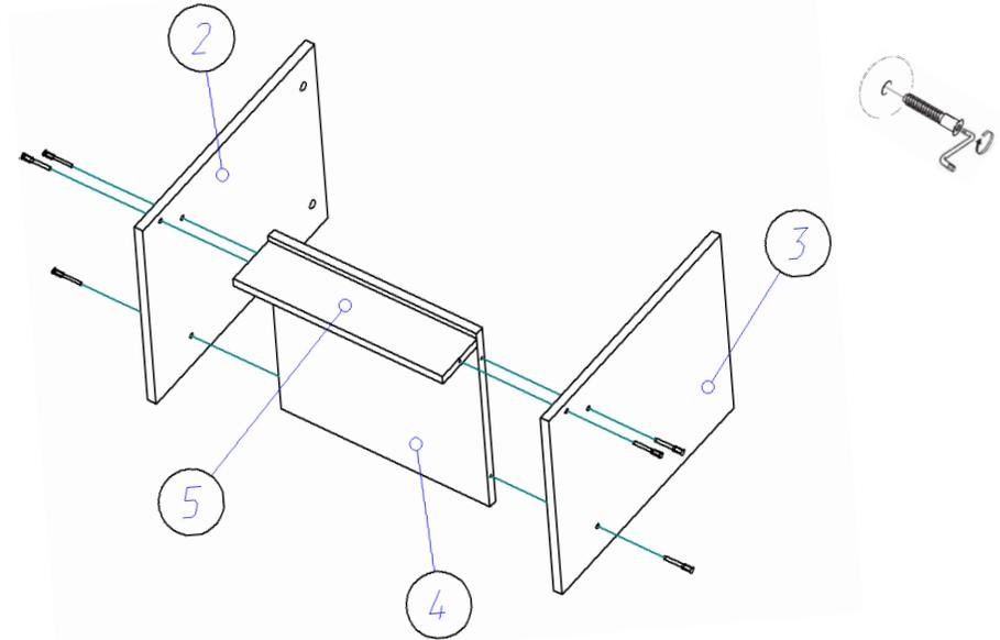
4. При помощи стяжек эксцентриковых и шкантов 8\*30 крепим крышку (1) к бокам (2,3), как показано на рисунке.
