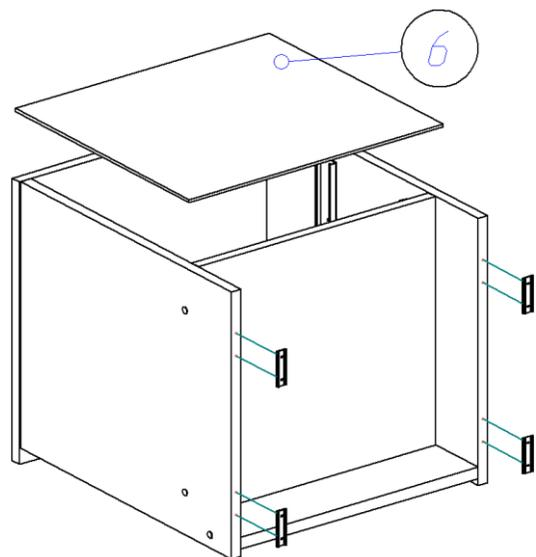
5. Соберем ящики. Евровинтами скрепляем бока ящика (Я.1, Я.2) и панель ящика (Я.3), прибиваем дно ящика ДВП (Я.5) (свес ДВП с незакромлённой стороны 6 мм). С помощью эксцентриковой стяжки крепим фасад (Я.4) к корпусу ящика (ДВП попадает в паз фасада). Прикручиваем с помощью саморезов 3,5\*16 направляющие на ящики.
