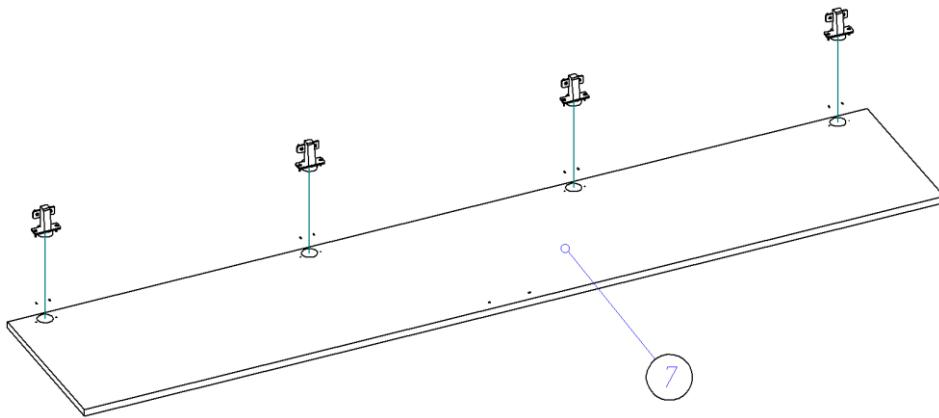
6. В отверстия на боках устанавливаем полкодержатели и кладем на них полки (8).
