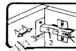
Если фасад наклонен вправо или влево относительно вертикали корпуса, нужно выпрямить наклон фасада в направлении А-А винтом 2.
