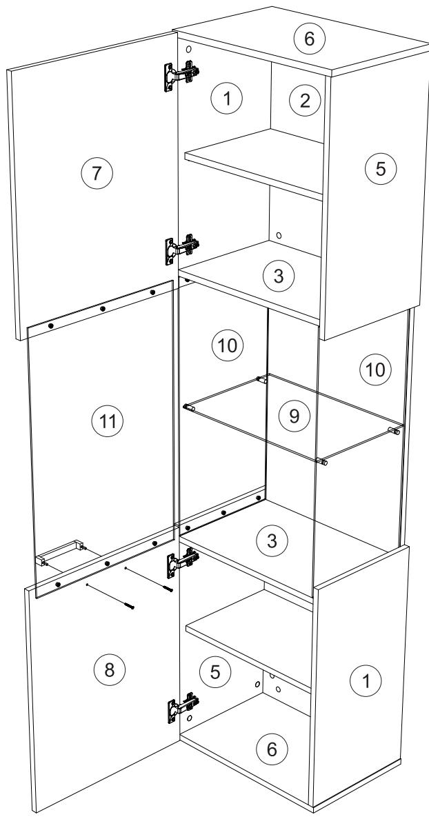
схема монтажа петли
