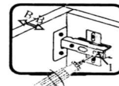
Если нижняя или верхняя часть фасада отстает от корпуса, нужно ослабить винт 1 и сдвинуть фасад в направлении В-В, а затем затянуть винт 1.
