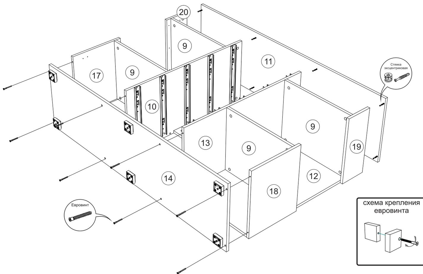
6) Закрепить задние стенки 5 и 12 к каркасам 9 евровинтами.
