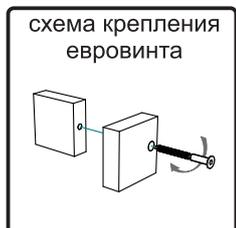
5) Закрепить крышку 14 к боковинам 17 и 18 и к перегородкам 10 и 13 евровинтами. Соединить крышку 11 с боковинами 19 и 20 и с перегородками 10 и 13 используя эксцентриковые стяжки.
