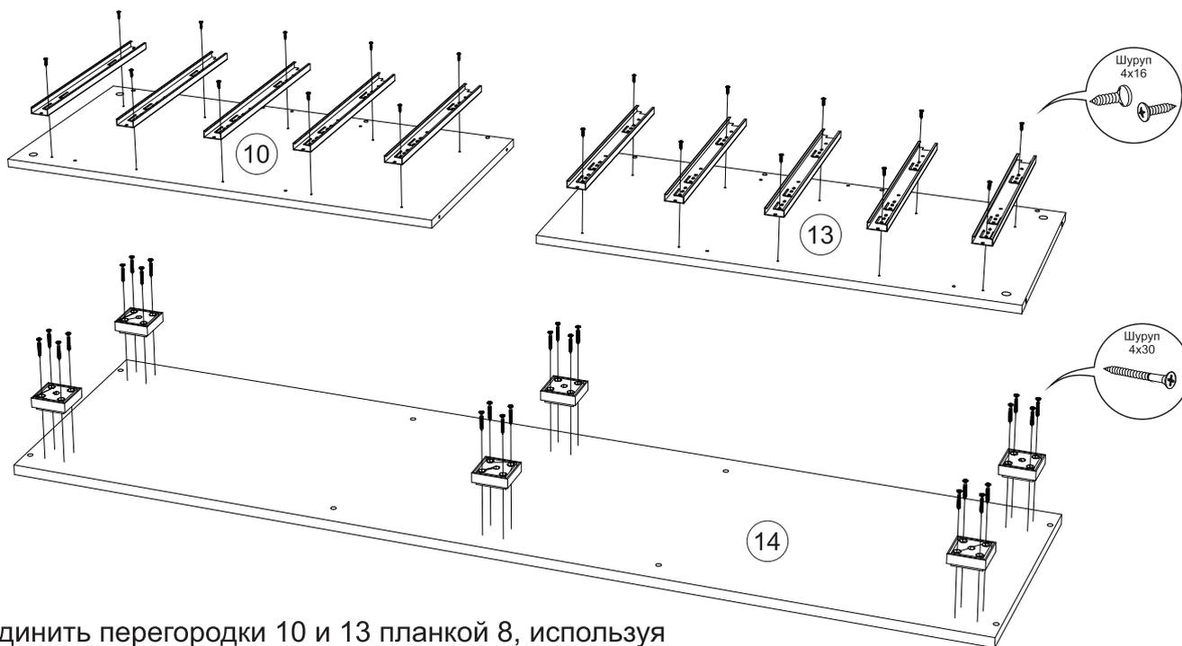
3) Соединить перегородки 10 и 13 планкой 8, используя эксцентриковые стяжки. Закрепить задние стенки 5 и 12 к перегородкам 10 и 13 евроинтами. Закрепить вязки 9 к перегородкам 10 и 13 эксцентриковыми стяжками.
