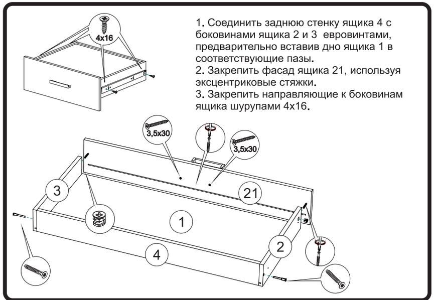
1. Соединить заднюю стенку ящика 4 с боковинами ящика 2 и 3 евровинтами, предварительно вставив дно ящика 1 в соответствующие пазы.
