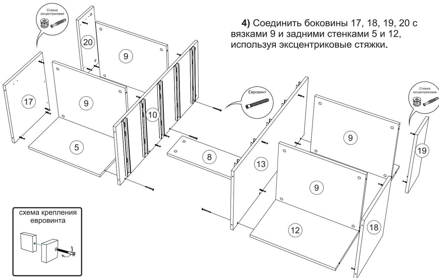
4) Соединить боковины 17, 18, 19, 20 с вязками 9 и задними стенками 5 и 12, используя эксцентриковые стяжки.
