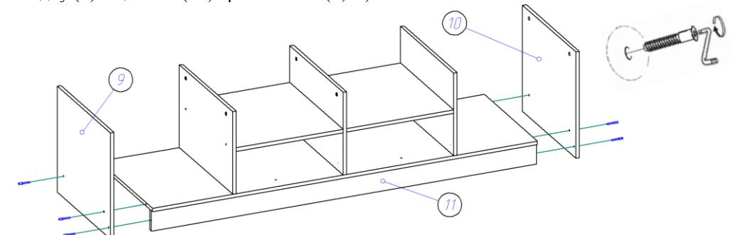
5. При помощи евровинтов 6,3\*50 собираем конструкцию, как показано на схеме.
