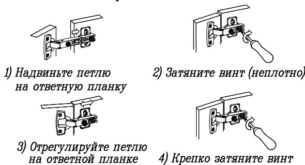
*Схема регулировки петли*
