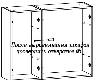
Во избежание опрокидывания шкафа, зафиксируйте его с рядом стоящими шкафами, просверлив самостоятельно отверстия Ø мм в стенках вертикальных и скрепив их между собой стяжкой межсекционной.
