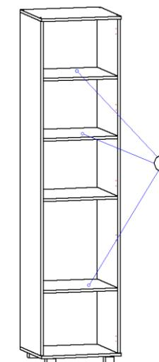
8. Устанавливаем фасады (7) по наколам в боковинах согласно схеме. На фасады устанавливаем ручки при помощи винтов (винты в комплекте с ручками). Производим регулировку фасадов согласно схемам, приведенным ниже.
