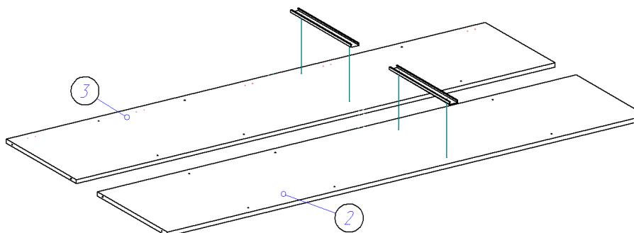
2. При помощи саморезов 3,5\*16 крепим опоры ко дну (1), как показано на рисунке.
