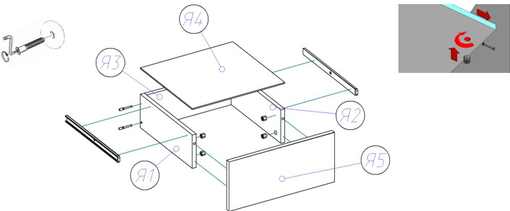
7. К фасаду прикручиваем саморезами 3,5\*16 петли. Принцип крепления петель одинаков для всех фасадов.
