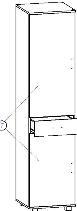
6. Собираем детали ящиков. Евровинтами скрепляем бока ящика и панель ящика, прибиваем дно ящика (ДВП) (свес ДВП с незакромленной стороны 6 мм). С помощью эксцентриковой стяжки крепим фасады к коробу ящика (ДВП входит в паз на фасаде). Саморезами 3,5\*16 на боках ящика крепим направляющие.
