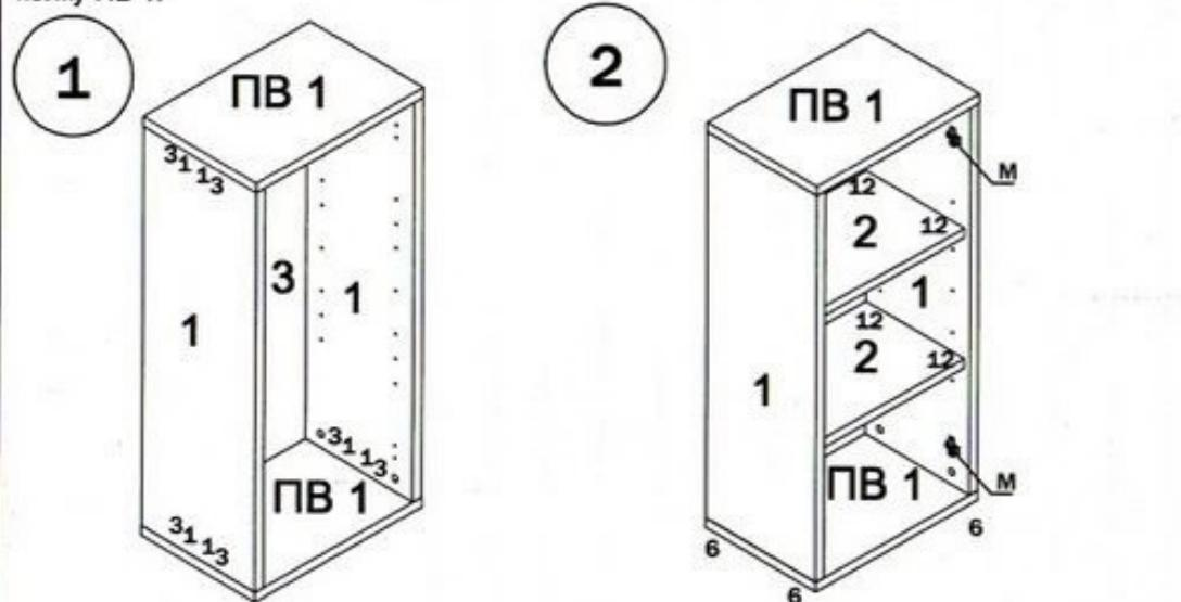
2. Установить в каркас модуля полки 2 при помощи усиленных стяжек ( 12 ) .К полке ПВ 1 прикрутить подпятники ( 6 )
