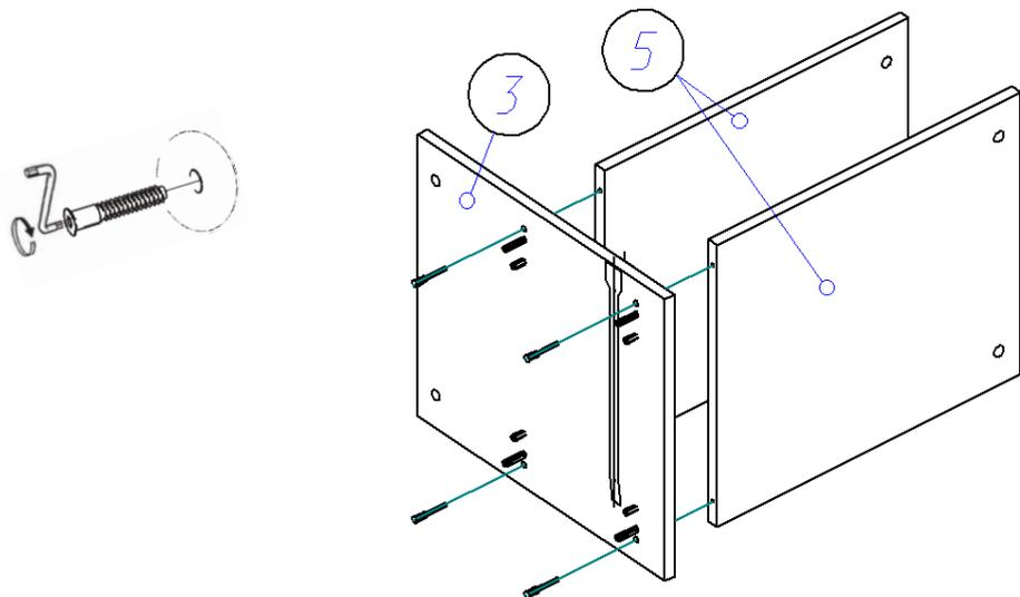
3. При помощи стяжек эксцентров и шкантов к стоевой (3) крепим горизонты (6) и (7). Далее полученную конструкцию, а также волнистые накладки (8), соединяем с боками (1) и (2).
