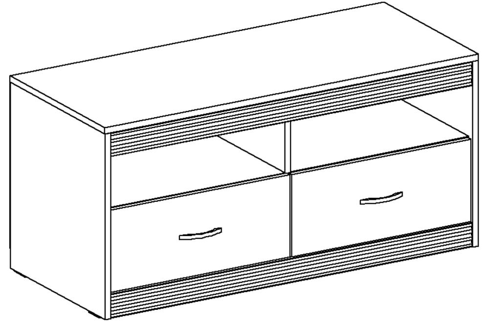
5. Переворачиваем полученный корпус тумбы лицевой стороной вниз, выравниваем диагонали и гвоздями 1,2\*20 прибиваем заднюю стенку ДВП (9) и подпятники. С помощью саморезов 3,5\*16 и уголков (стяжек «командор») скрепляем волнистые накладки (8) с горизонтом (6) и крышкой (4).
