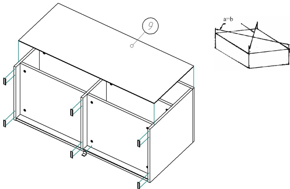
6. Собираем детали ящиков. Евровинтами скрепляем бока ящика и панель ящика, прибиваем дно ящика (ДВП) (свес ДВП с незакромленной стороны 6 мм). С помощью эксцентриковой стяжки крепим фасады к корпусу ящика (ДВП входит в паз на фасаде). Прикручиваем с помощью саморезов 3,5\*16 направляющие на ящики.
