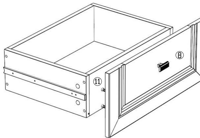
19. Установить внутрь изделия выдвижные ящики. На той половине направляющей, которая прикреплена к корпусу, имеется внутренняя подвижная часть. Необходимо выдвинуть и прижать ее к переднему краю направляющих.
