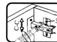
Если необходимо отрегулировать фасад по высоте, нужно ослабить винт 3, отрегулировать фасад в направлении С-С, а затем затянуть винт 3.
