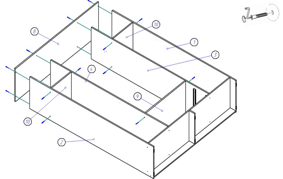
4. Гвоздями 1,2\*20 прибаваем задние стенки ДВП (12,13), как показано на рисунке. Между двумя листами ДВП (13) ставится соединительный профиль, поэтому прибавать второй лист ДВП нужно после установки этого профиля.
