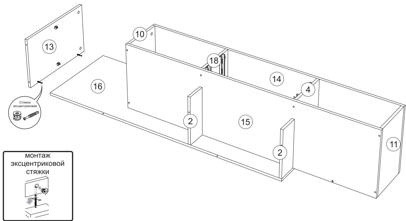
**10)** Закрепить крышку 12 к боковине 13, перегородкам 2 и задней стенке 16 евровинтами.
