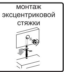
**5)** Закрепить перегородки 5 к крышке 14 евровинтами, перегородки 2 к крышке 15 шкантами.
