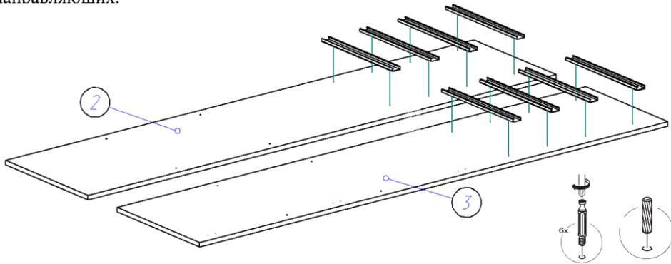
2. При помощи саморезов 3,5\*16 крепим опоры ко дну (1), как показано на рисунке.
