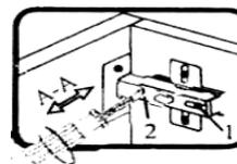
Если фасад наклонен вправо или влево относительно вертикали корпуса, нужно выправить наклон фасада в направлении А-А винтом 2.
