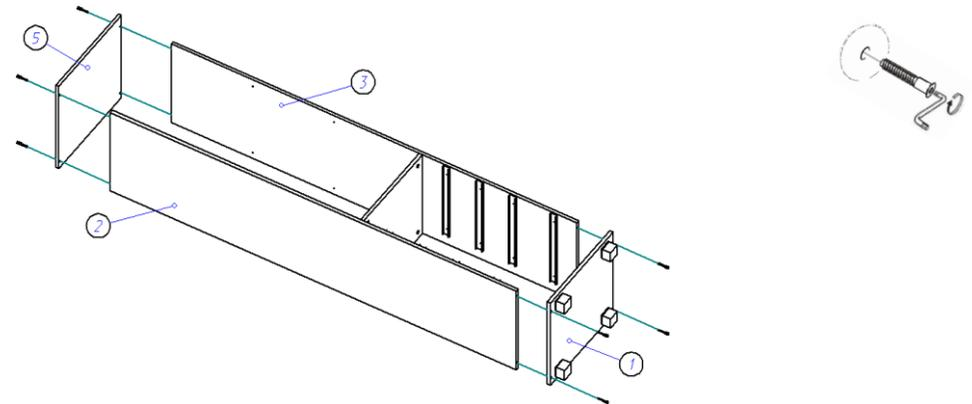
5. Переворачиваем каркас лицевой стороной в низ проверяем диагональ и прибиваем заднюю стенку (6) ДВП гвоздями 1,2\*20, вставив между ними соединительный профиль.
