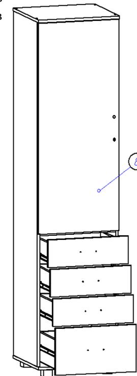
6. Собираем детали ящиков. Евровинтами скрепляем бока ящика и панель ящика, прибаваем дно ящика (ДВП) (свес ДВП с незакромленной стороны 6 мм). С помощью эксцентриковой стяжки крепим фасады к корпусу ящика (ДВП входит в паз на фасаде). Саморезами 3,5\*16 на боках ящика крепим направляющие.
