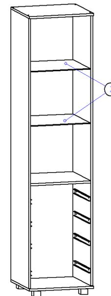
9. Вставляем ящики в пенал. Устанавливаем дверь с накладкой (8) по наколам в боковинах согласно схеме. На фасады устанавливаем ручки при помощи винтов (винты в комплекте с ручками). Производим регулировку фасадов согласно схемам, приведенным ниже.
