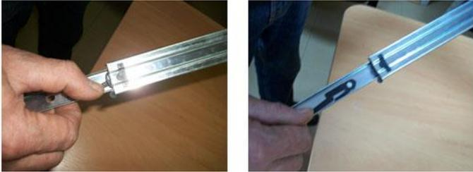
В отверстия на боках (2,3) устанавливаем штоки стяжек эксцентриковых и забиваем шканты 8\*30. Важно: установка шкантов производится только на ровной твердой поверхности. Саморезами 3,5\*16, к бокам (2,3), по наколам, широкие части направляющих.
