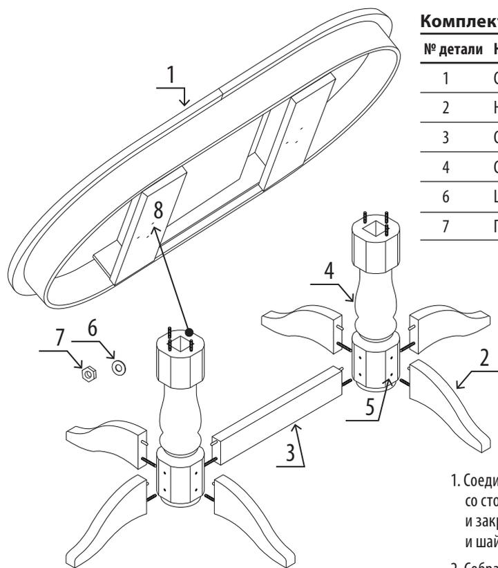
1. Соединить нижние опоры (2) со столбом (4) через отверстия (5) и закрепить при помощи гаек (7) и шайб (6).
