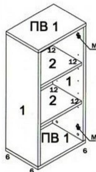
2. Установить в каркас модуля полки 2 при помощи усиленных стяжек (12) .К полке ПВ 1 прикрутить подплитники (6)
