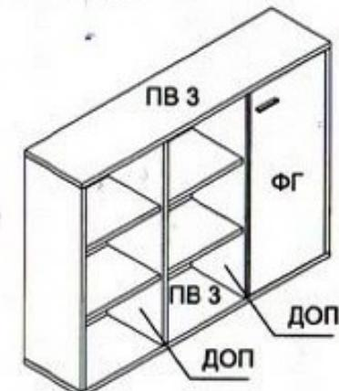
Для соединения второго яруса модулей с полками ПС 2 и ПС 3 используются шканты (5) .
