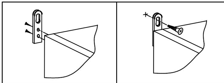
Во избежание опрокидывания шкафа, установите на задних торцевых поверхностях боковин прямой навес (см. фурнитуру) и через него притяните изделие к стене (дюбель-гвоздь в комплект не входит).
