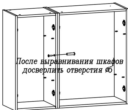
После выравнивания шкафов досверлить отверстия  $\varnothing 5$
