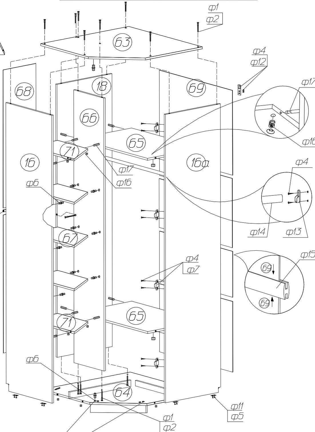
Установите полкодержатель  $\phi 6$  в одно из отверстий деталей 63 и 64 в зависимости от направления открывания двери.
