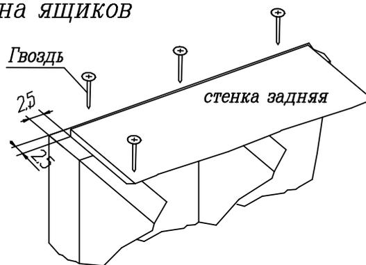
Начните сборку каркаса. Проверьте перпендикулярность и параллельность щитов и зафиксируйте с помощью задней стенки из ДВП, как указано на рисунке, не нарушая диагонали. Помните, что от этого зависит правильность работы выдвижных ящиков и створок.
