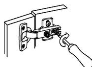
2) Затяните винт (неплотно)
