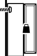
Крепежные средства идущие в комплекте, предназначены только для стен из бетона и полнотелого кирпича!
