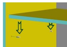
6. К фасаду прикручиваем саморезами 3,5\*16 петли. Принцип крепления петель одинаков для всех фасадов.
