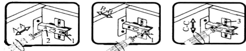
Если фасад наклонен вправо или влево относительно вертикали корпуса, нужно выпрямить наклон фасада в направлении А-А винтом 2.
