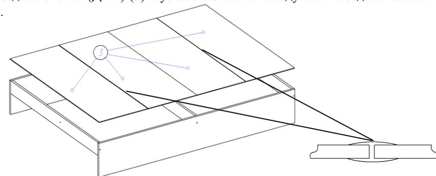
3. В отверстия на царгах вкручиваем муфты М6/10\*15. После этого к царгам саморезами 4\*30 прикручиваем планки (4), при этом открытые концы муфт попадают в пазы на планках. Двумя саморезами 4\*30 прикручиваем крайние бока короба для белья к царгам. Газовые лифты крепим к деталям подъемного механизма. Сам механизм болтами М6\*25 крепим к царгам. Болтами М6\*45 к механизму прикрепляем ортопедическое основание.
