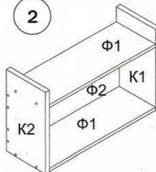
2. Забить шканты (1) в полку Ф1 и соединить ее с боковинами К1 и К2 при помощи евровинтов (2) .
