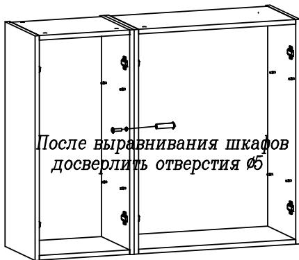
*Во избежание опрокидывания шкафа, зафиксируйте его с рядом стоящими шкафами, просверлив самостоятельно отверстия Ø мм в стенах вертикальных и скрепив их между собой стяжкой межсекционной.*
