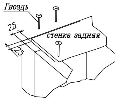
*Начните сборку каркаса. Проверьте перпендикулярность и параллельность щитов и зафиксируйте с помощью задней стенки из ДВП, как указано на рисунке, не нарушая диагонали. Помните, что от этого зависит правильность работы выдвижных ящиков и створок.*
