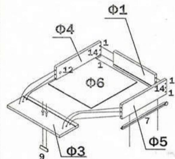
Взять стенку заднюю выдвижного ящика Ф1 и забить в соответствующие отверстия шканты (1). Соединить боковины ящика Ф4 и Ф5 с задней стенкой Ф1. Фиксацию производить при помощи евровинтов (14). Далее положить каркас ящика на заднюю стенку Ф1 и забить шканты (1) в соответствующие торцевые отверстия на боковинах ящика, Ф4 и Ф5 и вставить стяжки растекс (12) (см.рис.1). После этого вставить дно ящика Ф6 в пазы на каркасе ящика, таким образом, чтобы дно ящика Ф6 вошло в паз на стенке задней ящика Ф1.
