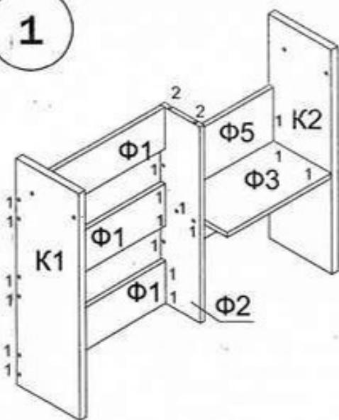
2. Забить шканты (2) в стойку среднюю Ф2. Соединить полку верхнюю Ф1 с каркасом надстройки (детали К1, К2 и Ф2). Фиксацию полки Ф1 с боковинами К1 и К2 произвести при помощи евровинтов (1).
