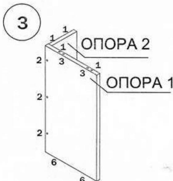
Закрутить в муфты столешницы Стол прям 120 дюбеля стяжек-растекс (4). Соединить столешницу с каркасом тумбы и опорой.
