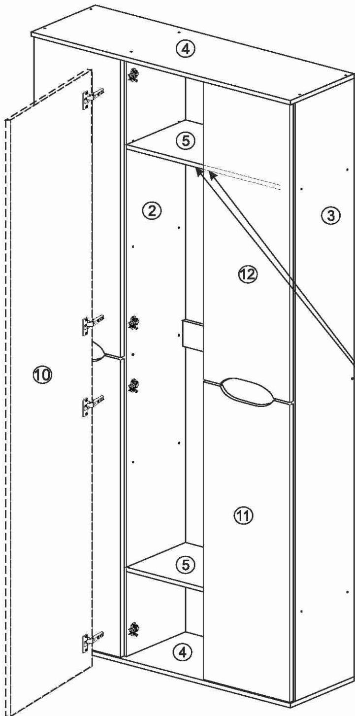
12. На фасад 10 (с зеркалом) необходимо прикрепить полунакладные петли, используя шурупы 4\*13 мм. Далее навесить готовый фасад.
