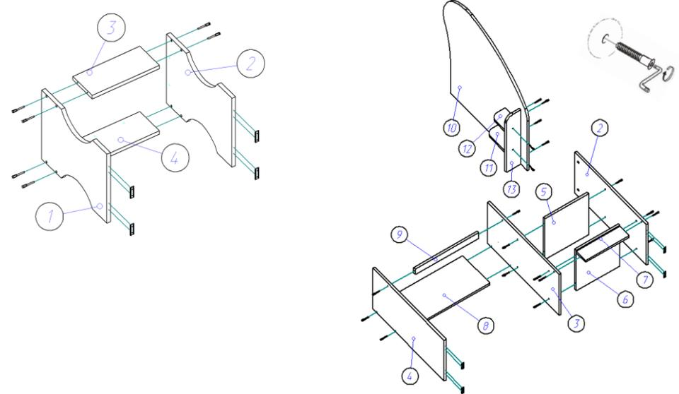
4. При помощи еврвинтов 6,3\*50 к крышке (1) прикручиваем панель (10), а при помощи стяжек эксцентриковых и шкантов 8\*30 крепим крышку (1) к бокам (2,3,4), как показано на рисунке. В отверстия на боках банкетки устанавливаем полкодержатели никель D5 и устанавливаем на них крышку (5)
