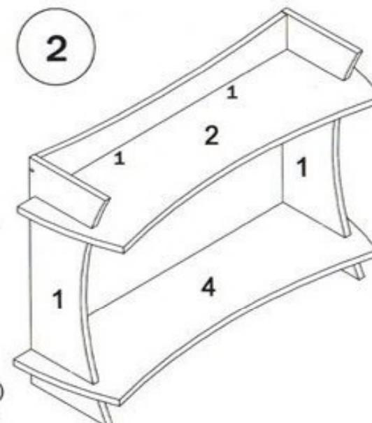
При необходимости , для уменьшения перемещения надстройки по столу ,на боковины 1 приклейте kleящие пятаки (3) . Затем снять защитную пленку с kleящих пятаков (3) , и только после этого надстройка устанавливается на стол.
