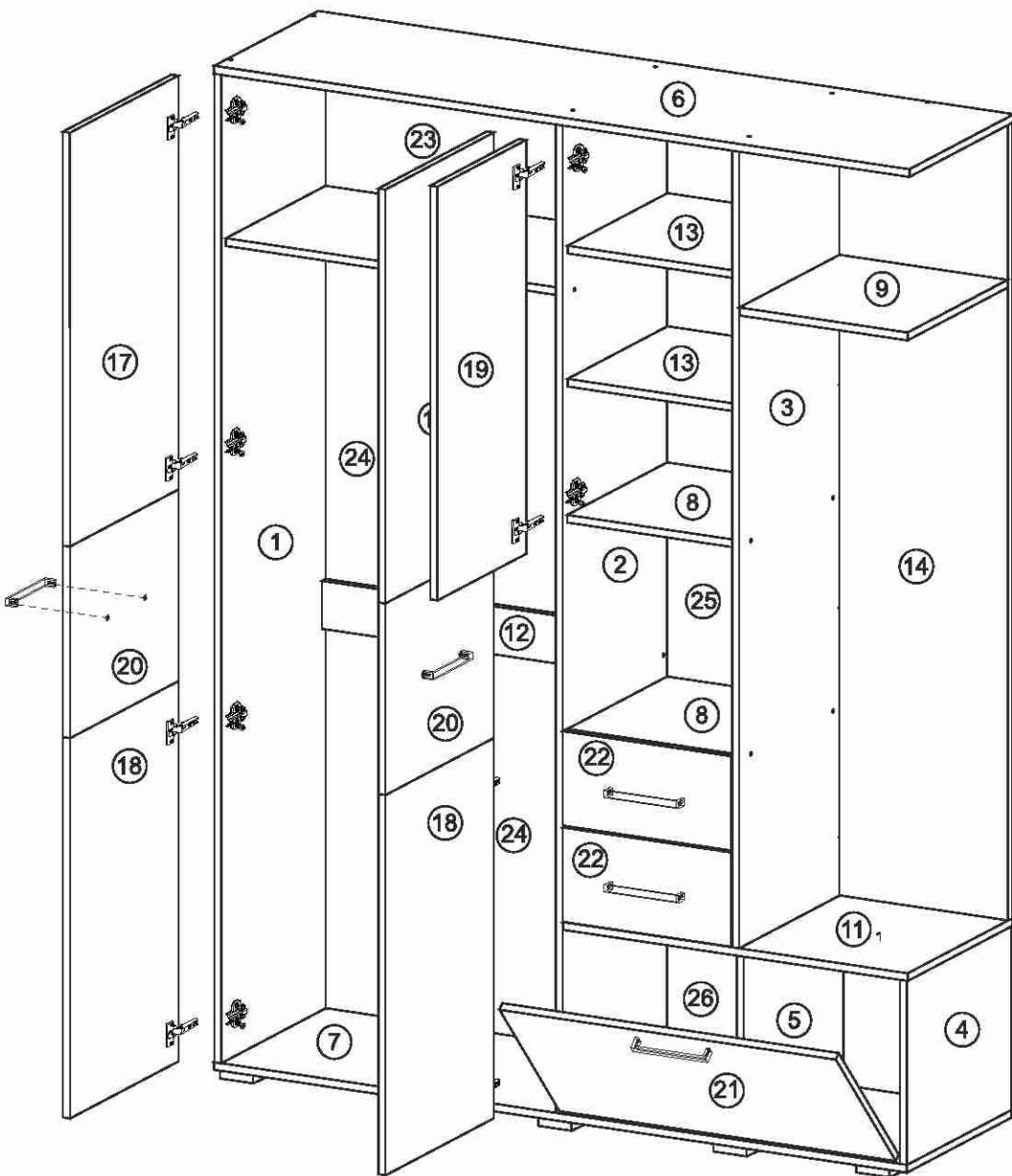
12. На створки 21, 19, а также на ранее собранные створки из деталей 17, 20, 18, установить вкладные петли шурупами 4\*13 мм. Для установки ручек на створки необходимо досверлить глухие отверстия диаметром 5 мм насквозь. Далее закрепить ручки саморезом и навесить створки.
