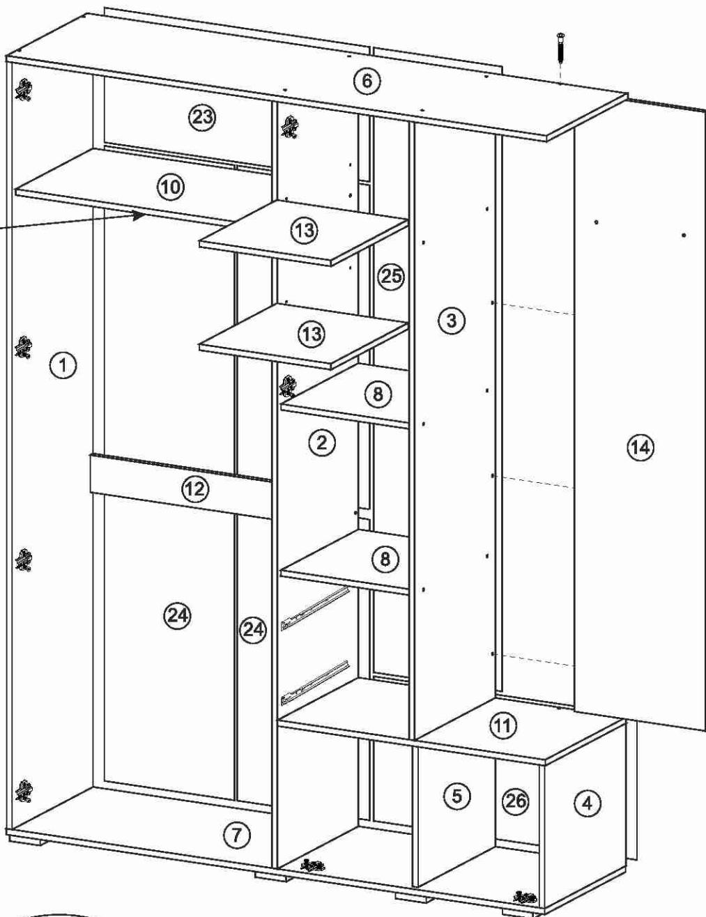
10. Для закрепления задних стенок 23, 24, 25 и 26 необходимо перевернуть собранную конструкцию лицевой стороной вниз. Между деталями 24 установить брус соединительный. Замерить и уровнять диагональ. После выверки закрепить ХДФ гвоздями, используя шайбу пластмассовую.
