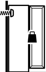
Крепежные средства идущие в комплекте, предназначены только для стен из бетона и полнотелого кирпича!
