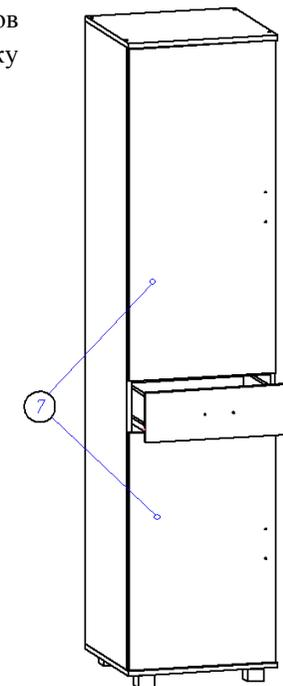
6. Собираем детали ящиков. Евровинтами скрепляем бока ящика и панель ящика, прибаваем дно ящика (ДВП) (свес ДВП с незакромленной стороны 6 мм). С помощью эксцентриковой стяжки крепим фасады к коробу ящика (ДВП входит в паз на фасаде). Саморезами 3,5\*16 на боках ящика крепим направляющие.
