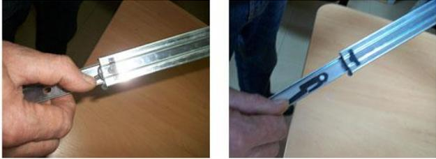
В отверстия на боках (2,3) устанавливаем штоки стяжек эксцентриковых и забиваем шканты 8\*30. Важно: установка шкантов производится только на ровной твердой поверхности. Саморезами 3,5\*16, к бокам (2,3), по наколам, крепим широкие части направляющих.
