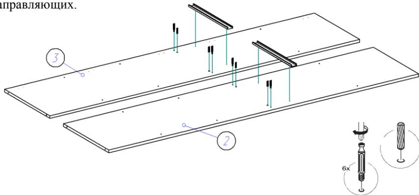
2. При помощи саморезов 3,5\*16 крепим опоры ко дну (1), как показано на рисунке.
