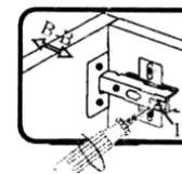
Если нижняя или верхняя часть фасада отстает от корпуса, нужно ослабить винт 1 и сдвинуть фасад в направлении В-В, а затем затянуть винт 1.
