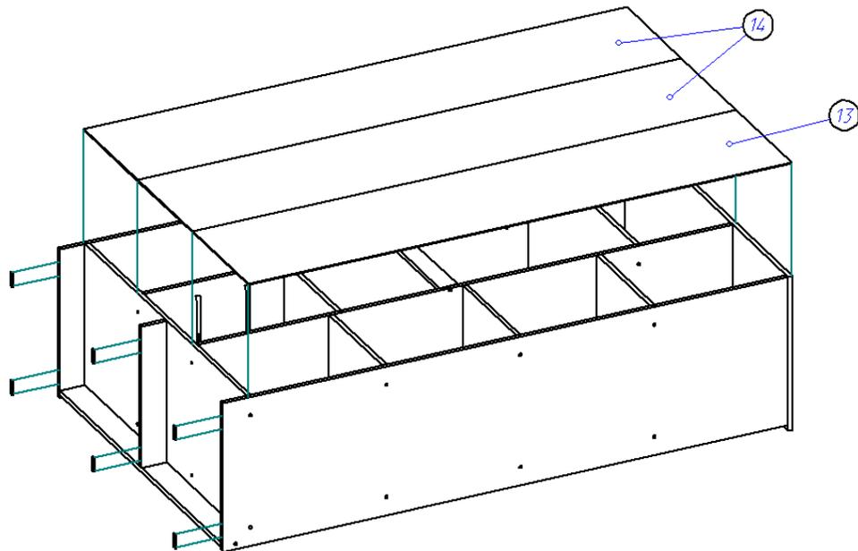
6. Соберем ящики. Евровинтами скрепляем бока ящика (Я.1, Я.2) и панель ящика (Я.3), прибиваем дно ящика ДВП (Я.5) (свес ДВП с незакромлённой стороны 6 мм). С помощью эксцентриковой стяжки крепим фасад (Я.4) к корпусу ящика (ДВП попадает в паз фасада). Прикручиваем с помощью саморезов 3,5\*16 направляющие на ящики.
