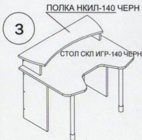
При необходимости, для уменьшения перемещения полки по столу, на боковины полки НКИЛ-140 ЧЕРН приклеить клеящие пяточки (6). Затем снять защитную пленку с клеящих пяточек (6), и только после этого полка НКИЛ-140 ЧЕРН устанавливается на стол СКЛ ИГР-140 ЧЕРН. Поставить декоративные заглушки (7) и (8) в местах установки евроинтов (2) и стяжек-растекс (3).
