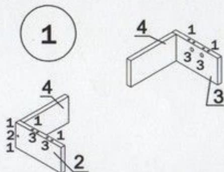
2. Закрутить дюбеля стяжки-растекс (4) в полку 1. Соединить полку 1 с опорами 2 и 3 собранными в п.1. Фиксацию полки к боковинам произвести при помощи стяжек-растекс (3).
