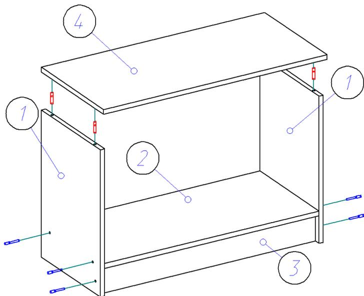
3. Для монтажа задней стенки тумбы изделие необходимо положить на пол лицевой частью вниз, замерить и уровнять диагонали. Положить сверху заднюю стенку ДВП (9), аккуратно выровнять углы и закрепить ДВП гвоздями 1,2\*20. Поставить изделие в вертикальное положение.
