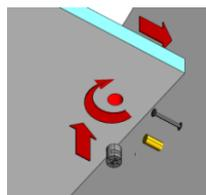
3. Далее к крышке (1) с помощью стяжек эксцентров и шкантов 8\*30 крепим стоевые (3,4,5,6). После этого, к стоевым (3,4,5,6) евровинтами 6,3\*50 присоединяем дно (2). Ко дну (2) саморезами 3,5\*16 прикручиваем опоры.
