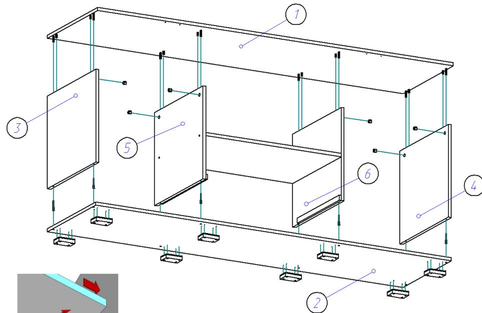
4. Полученный корпус тумбы переворачиваем лицевой стороной вниз, уравниваем диагонали и гвоздями 1,2\*20 прибиваем задние стенки ДВП (9,10).
