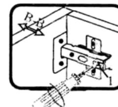
Если нижняя или верхняя часть фасада отстает от корпуса, нужно ослабить винт 1 и сдвинуть фасад в направлении В-В, а затем затянуть винт 1.
