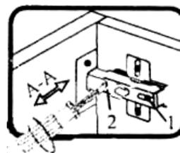
Если фасад наклонен вправо или влево относительно вертикали корпуса, нужно выправить наклон фасада в направлении А-А винтом 2.
