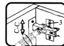
Если необходимо отрегулировать фасад по высоте, нужно ослабить винт 3, отрегулировать фасад в направлении С-С, а затем затянуть винт 3.
