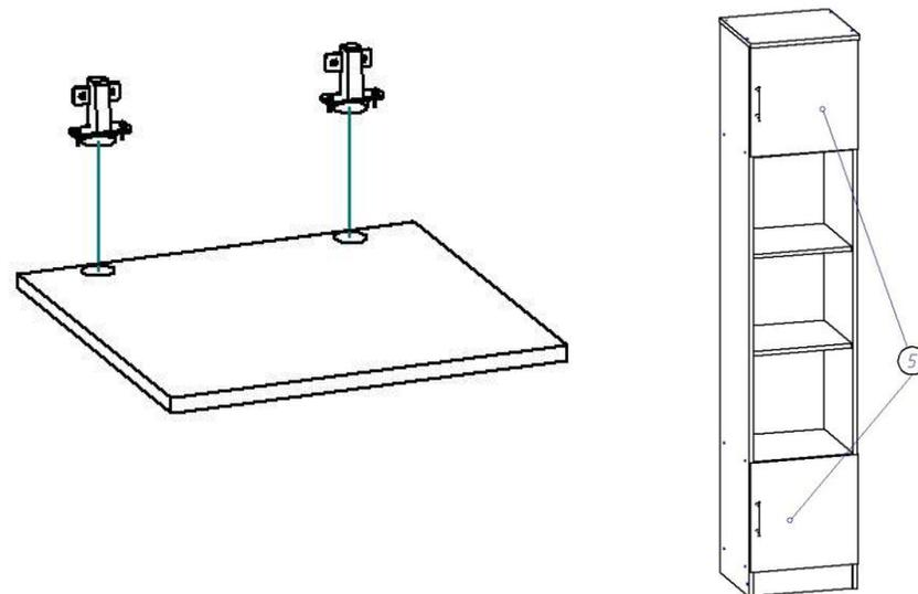
6. После того как навесили фасады (5) произвести регулировку его положения при помощи регулировочных и установочных винтов (рис).
