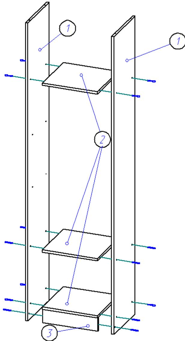
2. К полученной конструкции (см. пункт 1) с помощью евровинтов крепим крышку.
