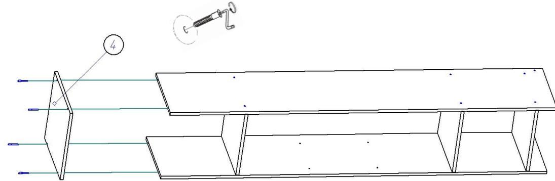
3. Для монтажа задней стенки пенала изделие необходимо положить на пол лицевой частью вниз, замерить и уровнять диагонали. Положить сверху заднюю стенку ДВП (7), аккуратно выровнять углы и закрепить ДВП гвоздями 1,2\*20.
